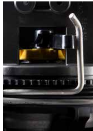
BUTÉES RÉGLABLES POUR UN SECTEUR SUR-MESURE
